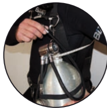
Inflator Schritt 1: Inflator unter Bungee durchziehen
