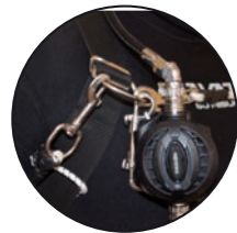
Linke Flasche Schritt 4: Das Weghängen erfolgt mit dem Doppelender am Blasenabweiser
