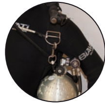
Linke Flasche Schritt 2: 1 m Schlauch ganz nach vorne ziehen und dann um den Hals legen
